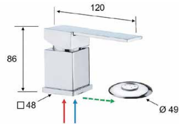
Monomando bidé Plana, cartucho 35mm con transmisión y válvula clic-clac
